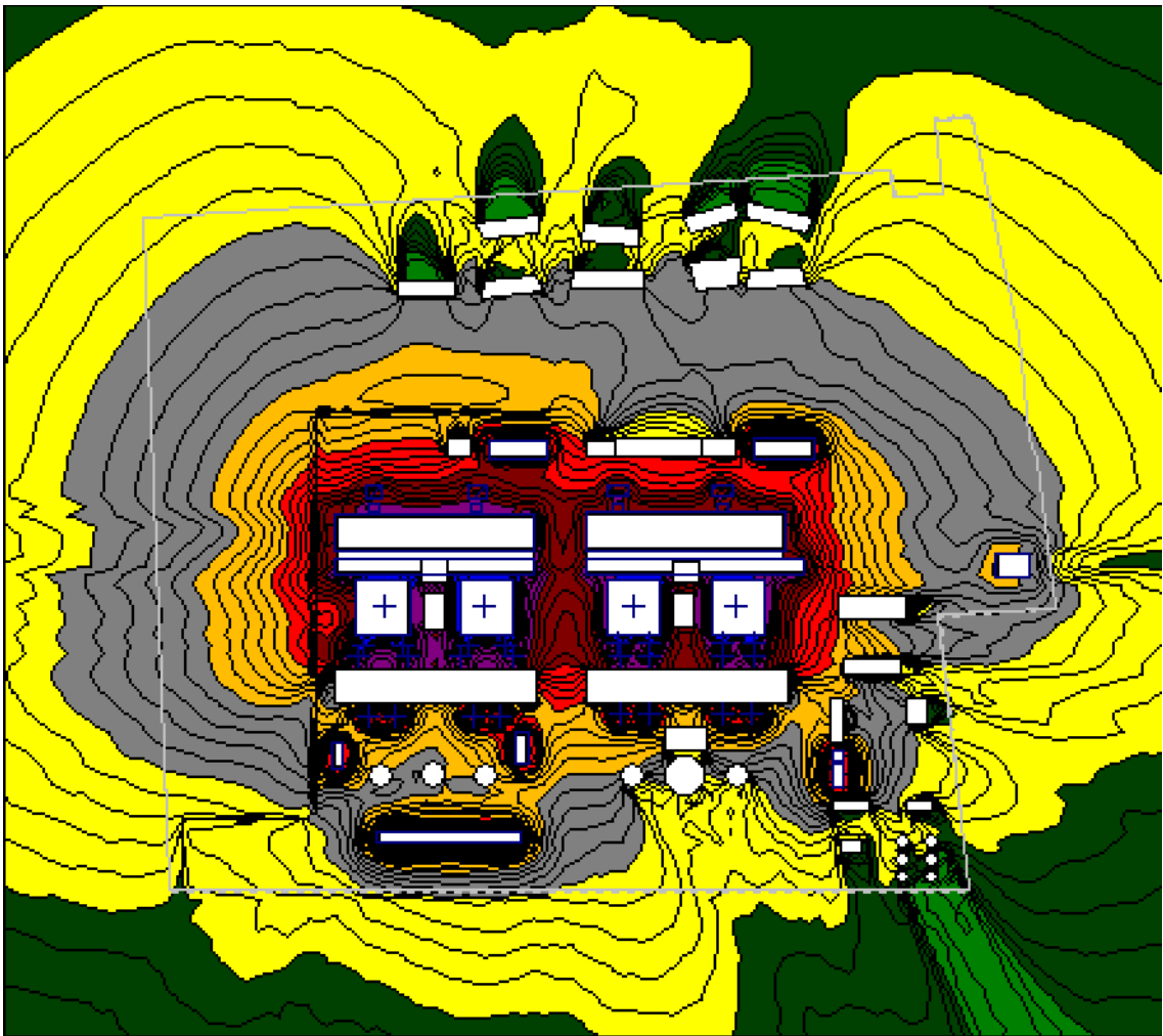
图 5.3-9 锅炉对空排汽情况下本期和一期声源叠加后电厂对周围环境的贡献值等声级曲线预测图（预测高度 1.5m）
