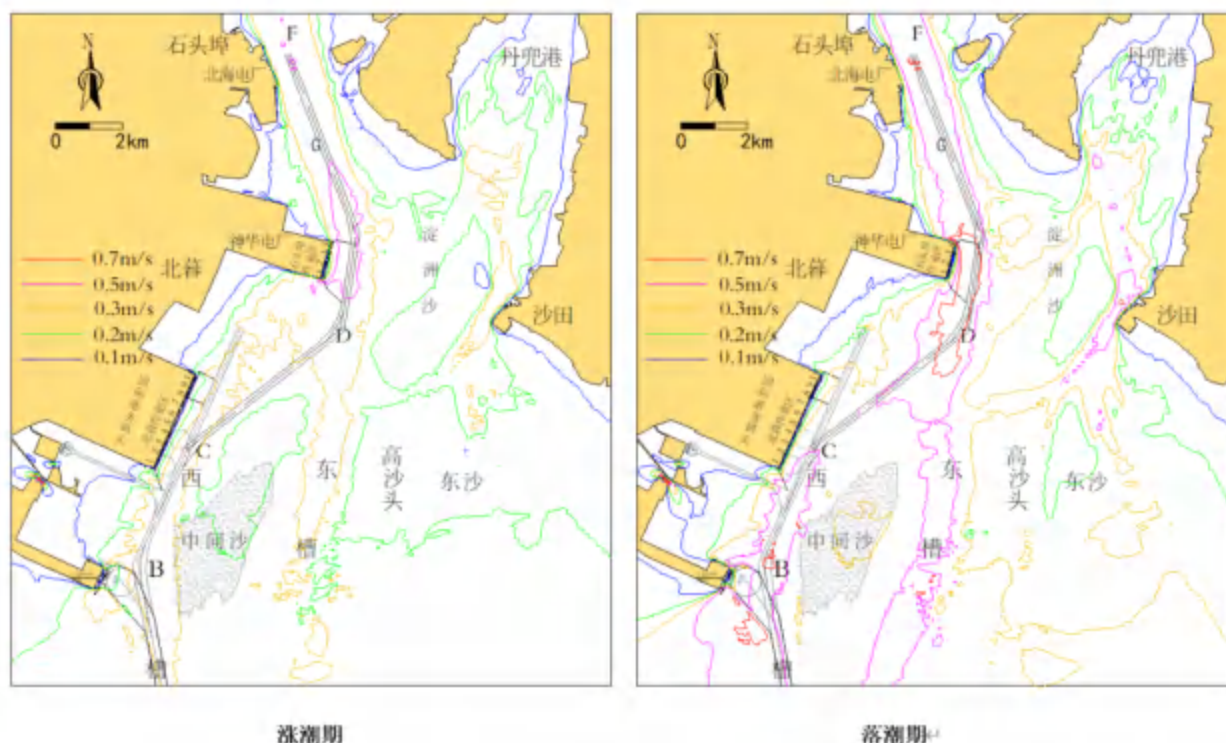
图 5.9-3 现状工况条件下大潮期铁山湾海域平均流速等值线分布图
